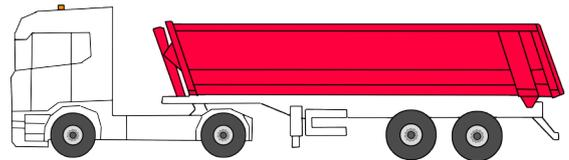
Ensemble semi 2 essieux acier, benne enrochement, pour chantiers complexes
