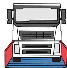
Décrotteur de roues pour gérer la propreté en sortie de chantier
