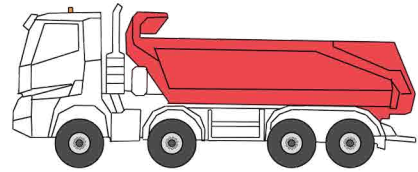
Porteur 8x4, benne enrochement équipé de bâche cramaro
